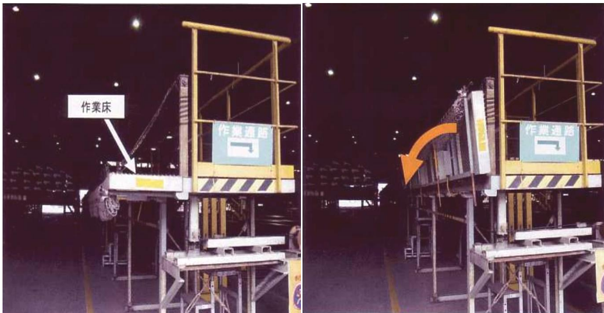
作業床を使用
